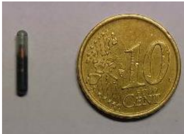
Obrázok 39. Podkožný pasívny zvierací transpondér
